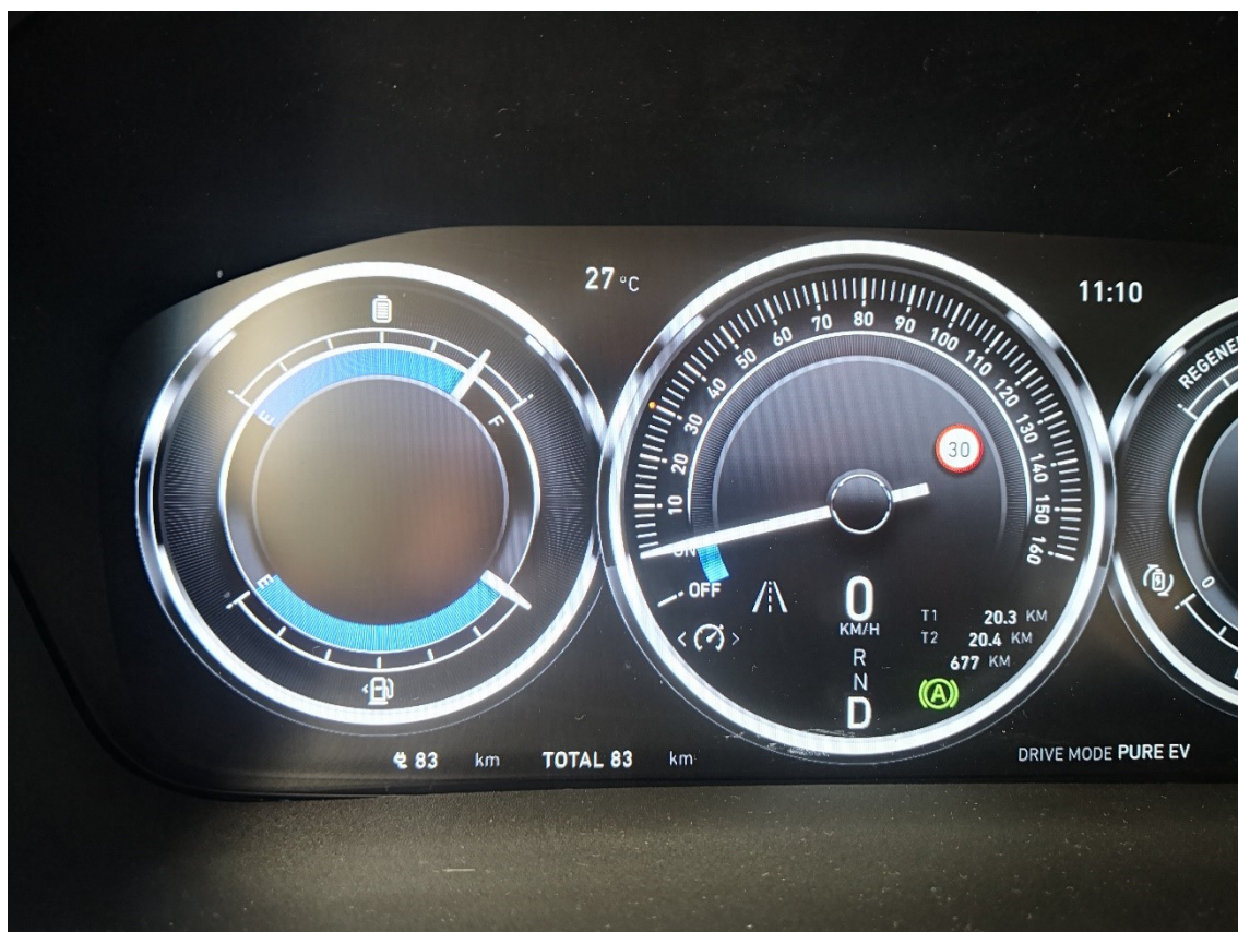
PRIMERA SEXTA PARTE DE LA BATERIA 20,3KM
