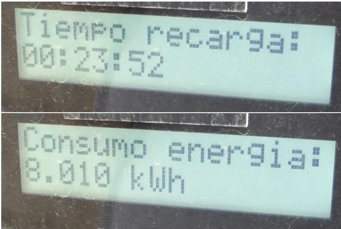
En 23 minutos y 52 segundos el LEVC carga 8010kwh lo que significa que la media de velocidad de carga en ese tiempo ha sido de poco más de 20kwh.
