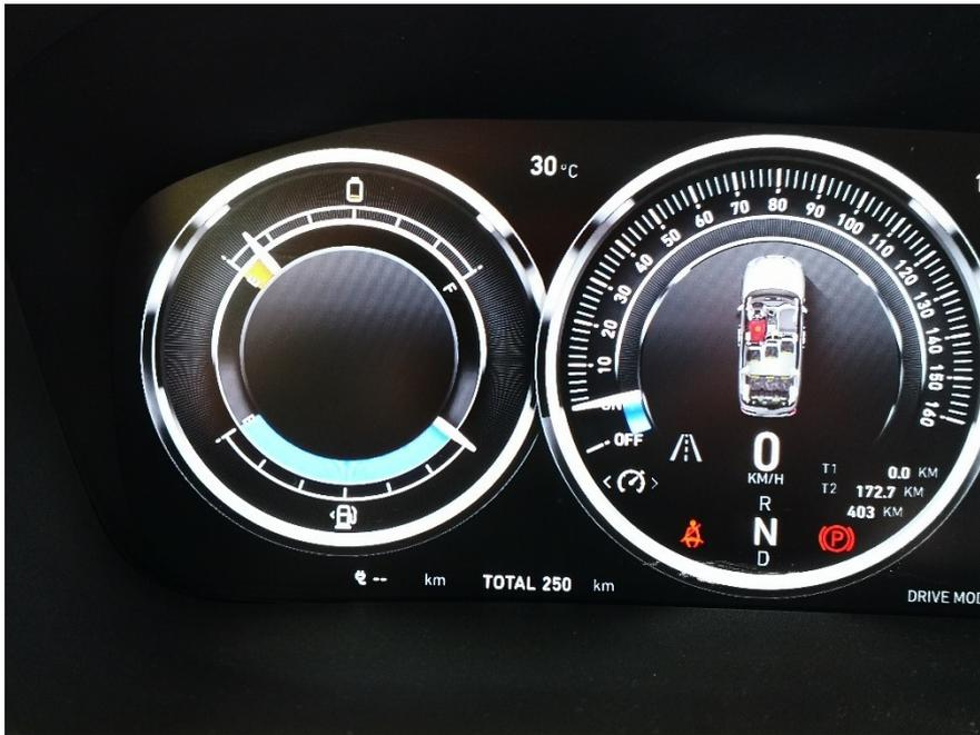
BATERIA AL MINIMO. CUANDO SE ENCIENDE EL EXTENSOR DE AUTONOMIA CARGA HASTA LLEGAR A LA RALLA DE SEXTA PARTE Y HASTA QUE NO SE DESCARGA A LA MITAD DE LA SEXTA PARTE NO VUELVE A ENCENDERSE DE NUEVO. EN LA FOTO ESTA A PUNTO DE VOLVER A ENCENDERSE.
