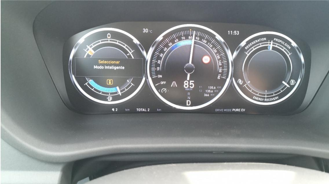
PRIMER AVISO DE CAMBIAR EL MODO DE CONDUCCIÓN PARA PERMITIR QUE SE ENCIENDA EL MOTOR DE COMBUSTIÓN PARA PRODUCIR ELECTRICIDAD A LOS 135KM.
