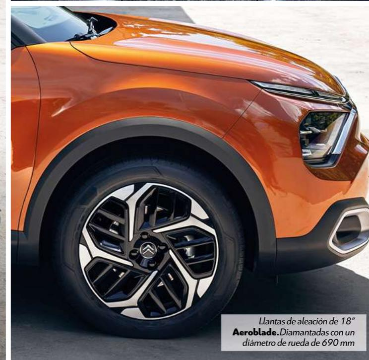
Llantas de aleación de 18" **Aeroblade**. Diamantadas con un diámetro de rueda de 690 mm
